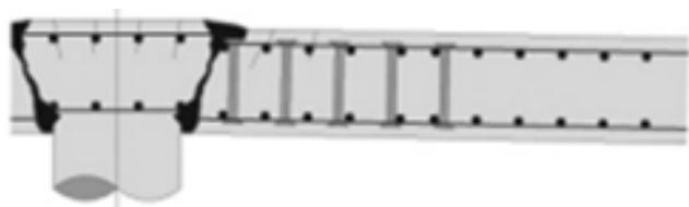
Cedarea în apropierea stâlpului prin zdrobirea betonului
