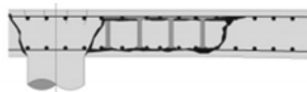
Desprinderea miezului de beton
